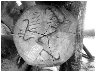
図 32 FSC ラベルの貼られた原木。割れ防止のため、S 管が打ち込まれている。
